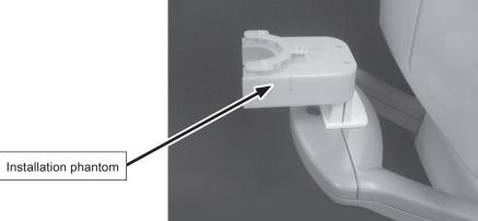
Fig. ® -56: Installation phantom
